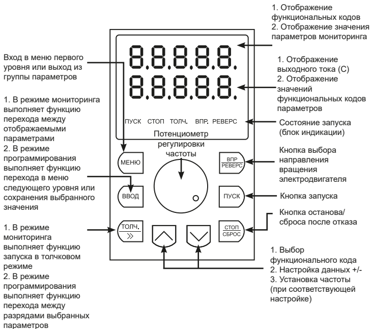
Рисунок 6 – Описание панели управления LCI-KP
