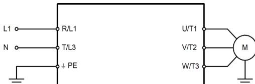
Рисунок 2в – Подключение силовых клемм для моделей LCI-GY/PY-3
