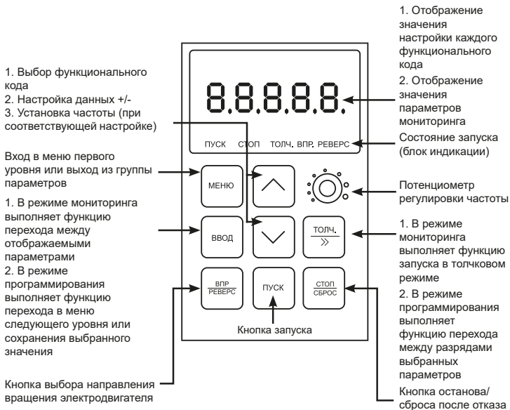
Рисунок 5 – Описание панели управления LCI-KP-S
