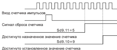
Рис. 6.23 - Работа функции счетчика импульсов
