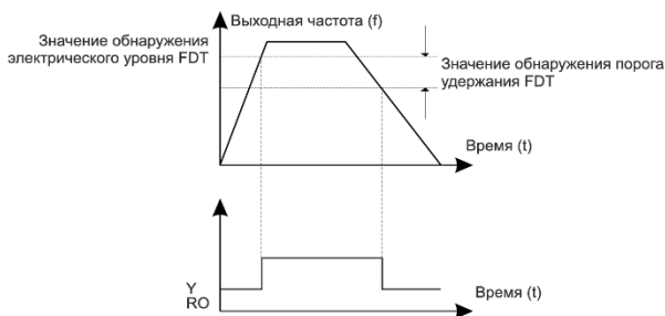
Рис. 6.13 - Значения обнаружения выходной частоты
