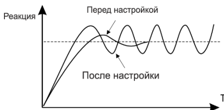
Рис. 6.22 - Контроль вибрации повышенной частоты
