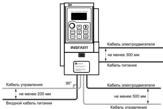
Рис. 3.7 - Графическое представление расстояний между кабелями
