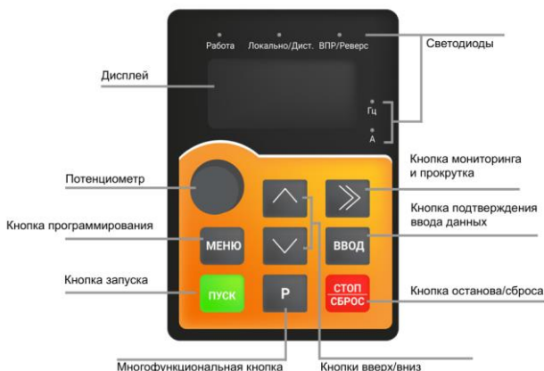
Рис. 5.1 - Функции кнопок и светодиодов панели управления SDI
