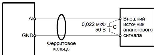
Рисунок 3.11 – Схема подключения проводов к аналоговому входу (при воздействии сильных помех)
