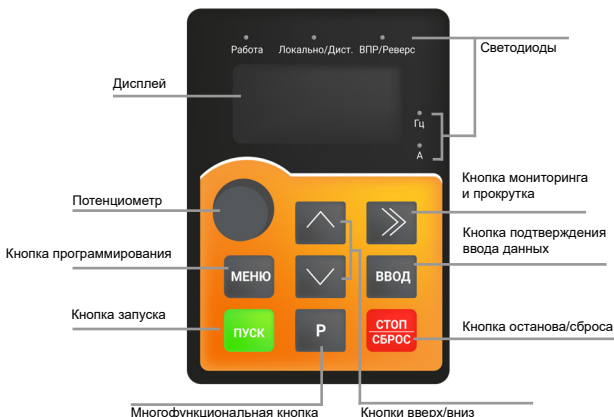
Рис. 5.1 - Функции кнопок и светодиодов панели управления SDI
