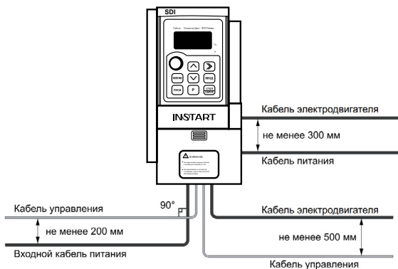
Рис. 3.7 - Графическое представление расстояний между кабелями
