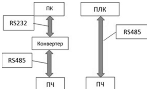
Рисунок 7.1 - Сетевой режим Master/Slave
