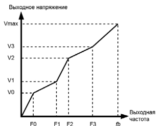
б) Многосегментная кривая напряжение-частота
