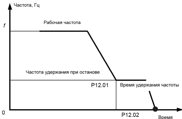
Рис.6.11. Схематическое изображение для частоты удержания при останове
