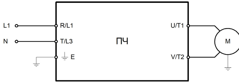
Подключение силовых клемм для моделей LCI-GY/PY-1
