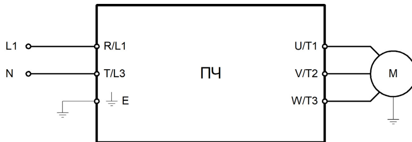
Подключение силовых клемм для моделей LCI-GY/PY-3
