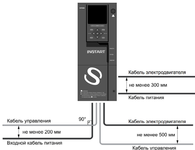
Рис. 3.7 Графическое представление расстояний между кабелями
