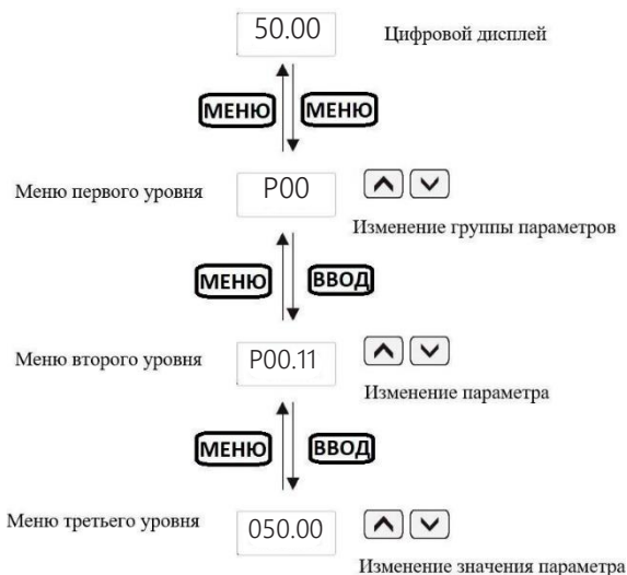
Рисунок 6.1 – Схема настройки параметров меню
