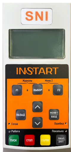
SNI-KP LCD-панель Степень защиты IP55
