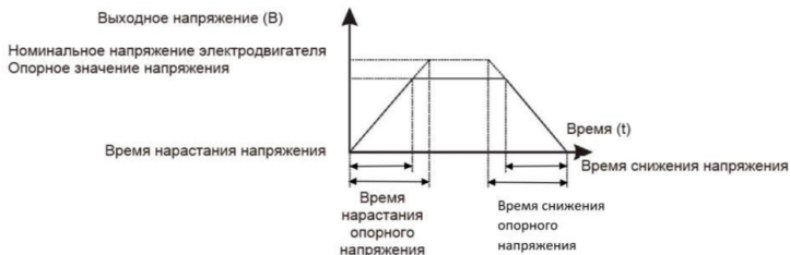
Рис. 6.8 — Время нарастания и снижения напряжения
