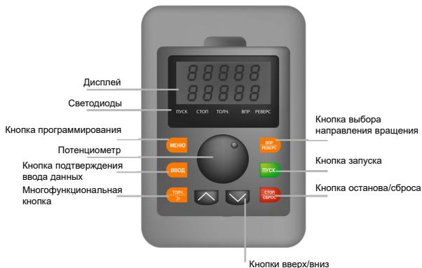
Рис. 5.1 – Функции кнопок и светодиодов панели управления LCI
