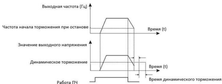
Рисунок 6.4 – Процесс торможения постоянным током
