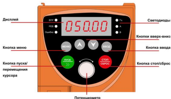
Рисунок 5.1 – Функции кнопок и светодиодов панели управления INVENT
