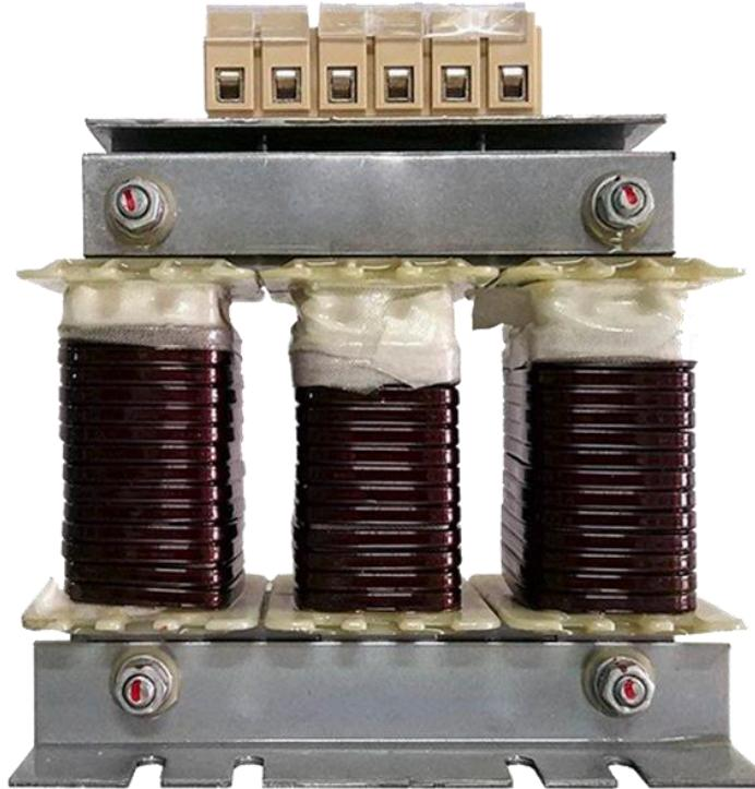
**Моторные дроссели (IMF)** представляют собой пассивное устройство в виде электромагнитных катушек с магнитопроводами. Они предназначены для снижения скорости нарастания пульсаций тока на выходе преобразователя частоты
