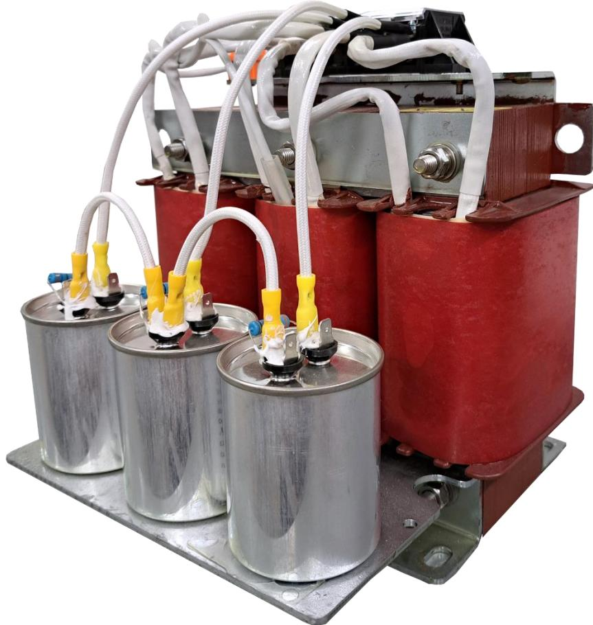
**Выходной синусный фильтр ISINOF** - это пассивное устройство на основе индуктивностей и ёмкостей. Устанавливается после частотного преобразователя для изменения импульсного (ШИМ) напряжения в форму, максимально приближенную к чистой синусоиде.
