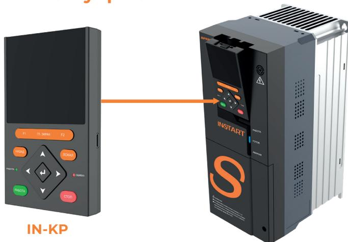
Съемная LCD-панель предназначена для управления преобразователем частоты. Она позволяет осуществлять запуск, останов, регулирование частоты, а ЖК-дисплей обеспечивает удобное программирование и мониторинг, включая возможность просмотра осциллограмм.
