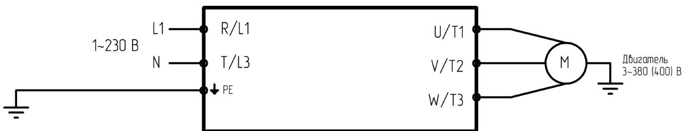
Рисунок 5. Подключение силовых клемм
