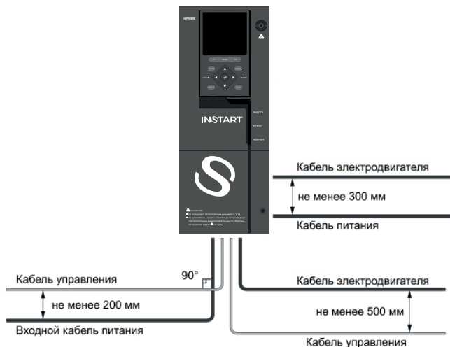
Рис. 3.6 Графическое представление расстояний между кабелями
