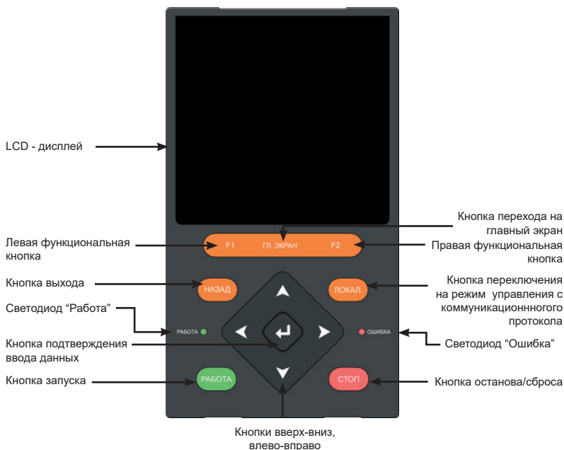
Рис. 5.1 Функции кнопок и светодиодов панели управления INPRIME
