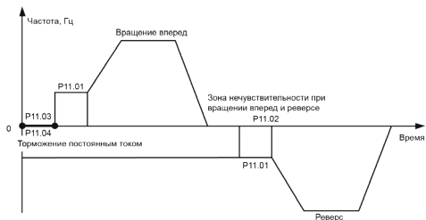
Рис.6.6 Схема запуска после торможения постоянным током
