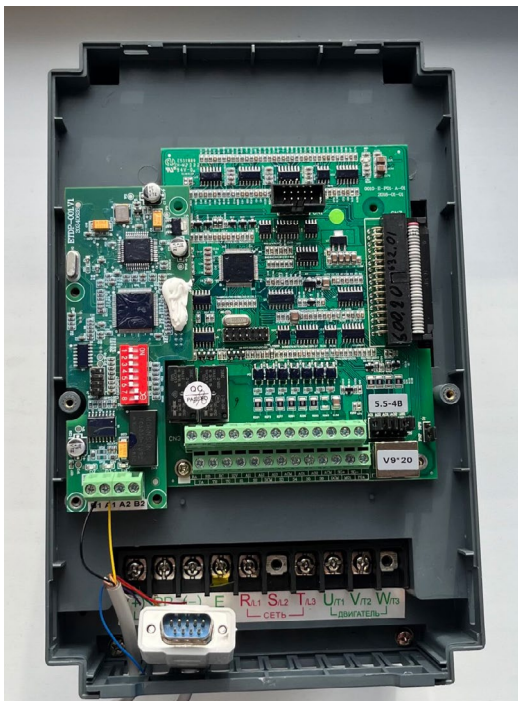
Рисунок 29 – Подключение кабеля с разъемом D-sub-9
