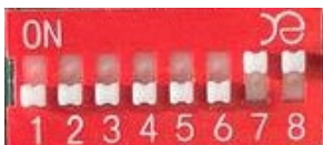
Рисунок 2 – Положение DIP-переключателя на плате LCI-DP
