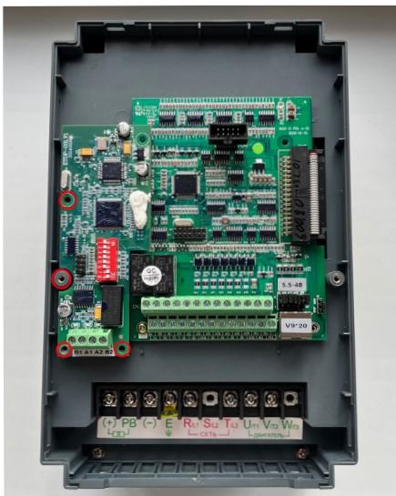
Рисунок 28 – Крепежные отверстия платы расширения LCI-DP
