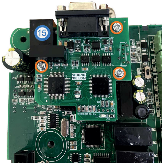
Рисунок 11 – Крепежные винты платы расширения SNI-DP-S
