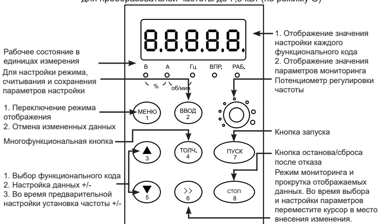
Рис. 4 – Описание панели управления FCI-KP-S
