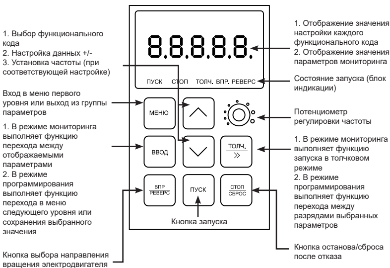
Рисунок 5 – Описание панели управления LCI-KP-S
