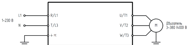
Рисунок 2в – Подключение силовых клемм
