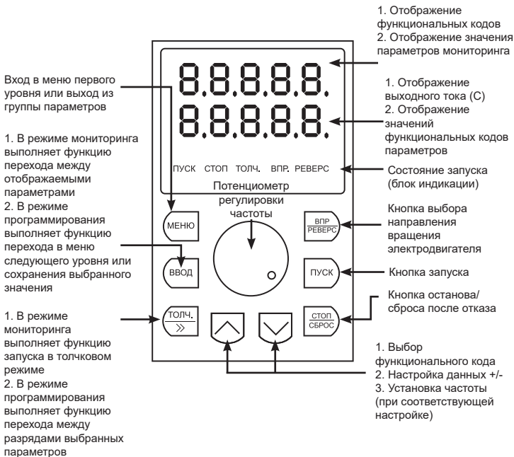
Рисунок 6 – Описание панели управления LCI-KP
