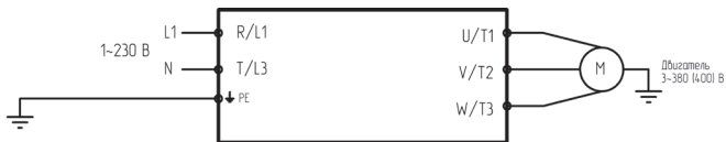
Рисунок 2в – Подключение силовых клемм
