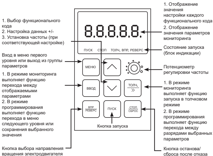
Рисунок 5 – Описание панели управления LCI-KP-S
