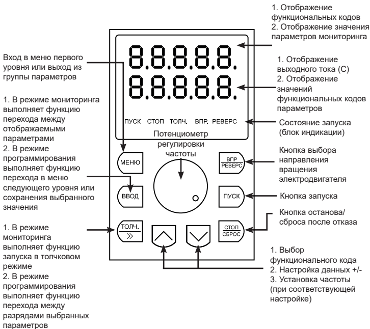
Рисунок 6 – Описание панели управления LCI-KP
