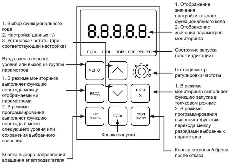
Рисунок 5 – Описание панели управления LCI-KP-S
